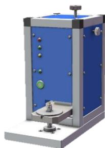
Pour Lemo, la qualité de leurs produits est importante, c'est pourquoi mon travail de diplôme consiste à assembler, programmer et mettre en service un appareil de mesure servant au contrôle de la force nécessaire à débrancher les connecteurs Lemo afin qu'ils répondent aux critères de qualité.
